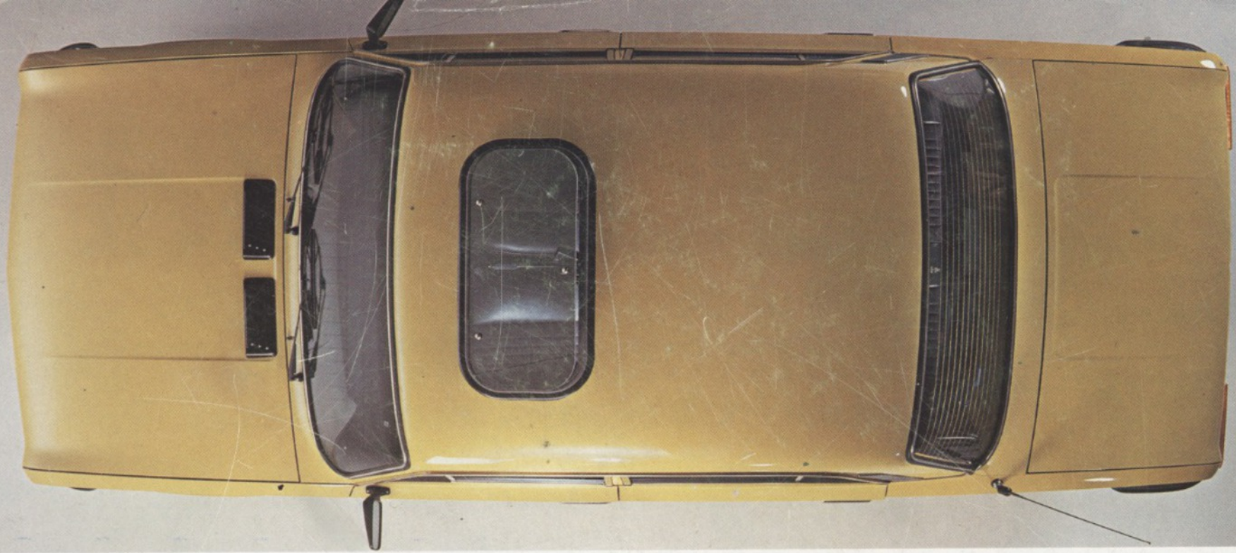
AUKAISTAVA KATTOIKKUNA. Lapponiassa on peilityyppinen kattoikkuna, jonka läpinäkyvyys autosta ulospäin on hyvä, mutta ulkopuolelta katseltuna aurinkolasien tapaan peilaantuva. Kattoikkuna on ehdottoman vesitiivis ja ajon aikana avoimenakin vedoton.
